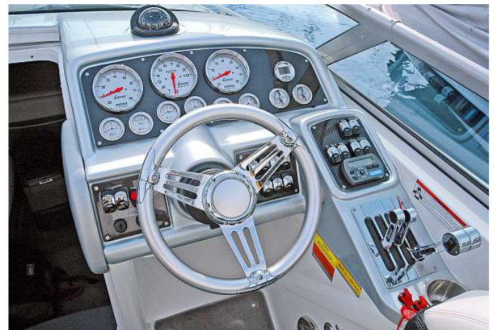
Typisch für einen Offshorer: Mit weniger als drei Ruderdrehungen zwischen den Anschlägen reagiert die Lenkung angenehm direkt
