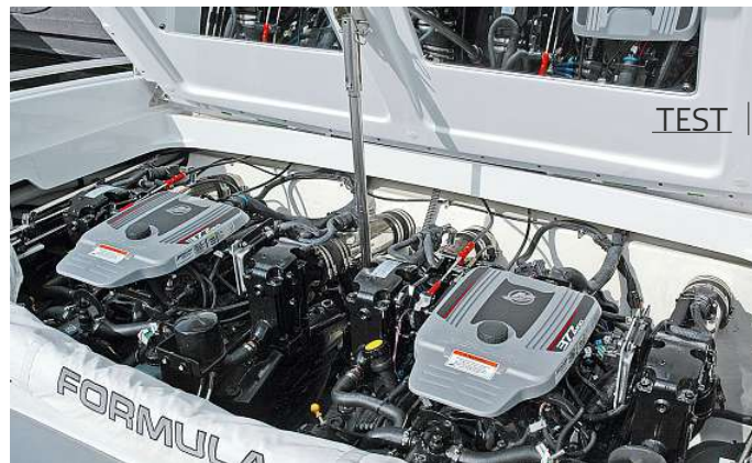
MerCruiser-Power im Doppelpack: Die V8-Benziner leisten 470 kW
