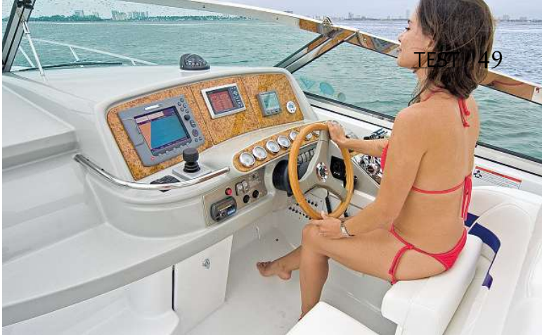
Der Axis-Joystick ist unauffällig vor dem Kartenplotter platziert
