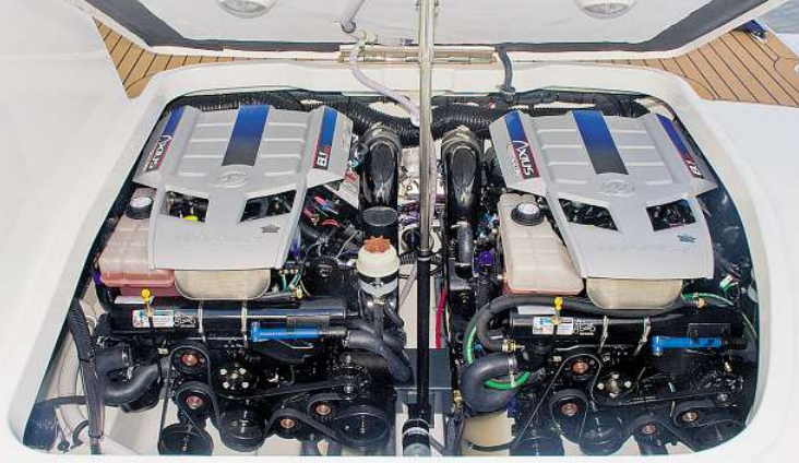
Die MerCruiser-V8-Triebwerke leisten 2 x 317 kW
