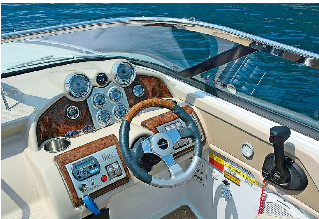
Zwischen Backbord- und Steuerbordanschlag liegen angenehm direkte 2,5 Ruderdrehungen
