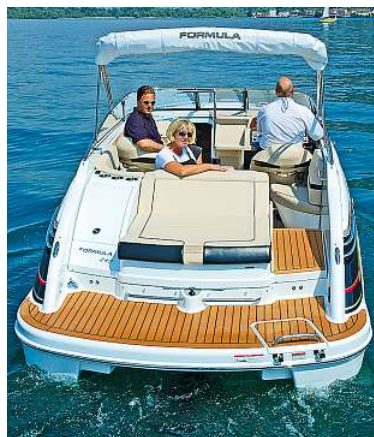
Der in die Form integrierte Badesteg wurde mit Flexiteek aufgewertet
