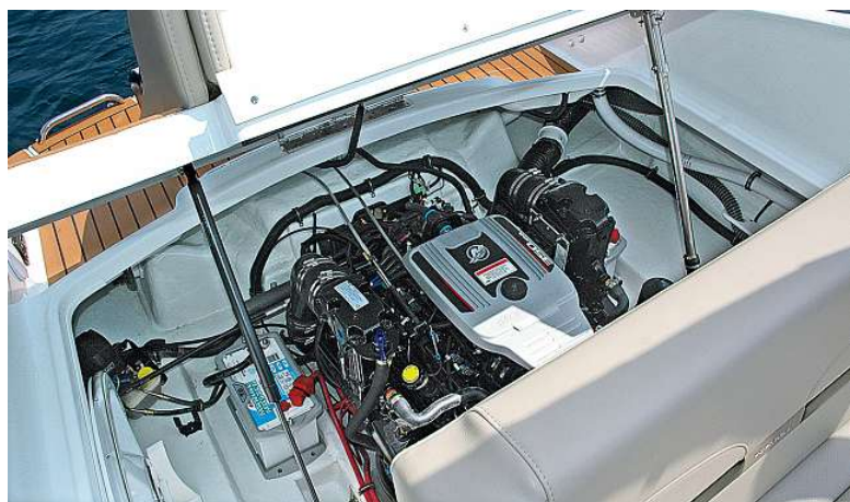
Pieksaubere Motorinstallation, die zum perfekten Finish des gesamten Bootes passt. Der V8-MerCruiser generiert satte 221 kW
