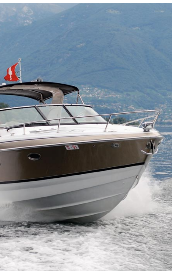
Leerlauf: 630 U/min, Höchstgeschwindigkeit: 82,9 km/h bei 4500 U/min Gemessen mit GPS, 2 Personen an Bord, flaches Wasser, windstill
