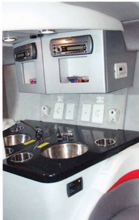
Eviers à pression d'eau près de l'entrée de la cabine.
