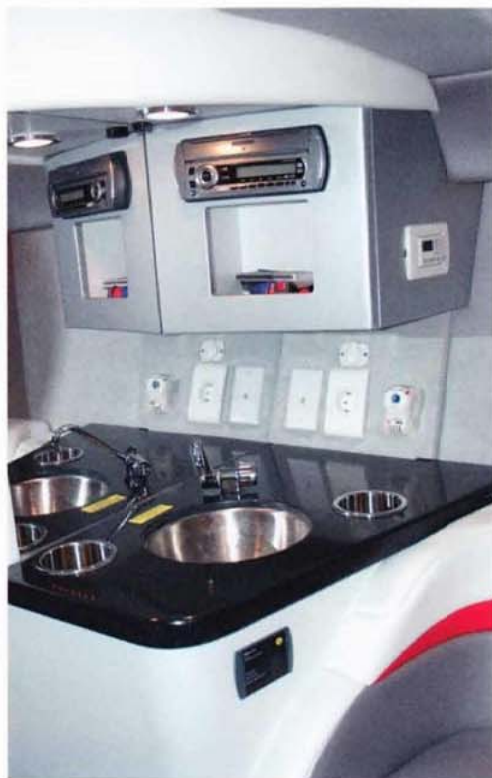
Lavello con acqua a pressione vicino all'ingresso cabina
