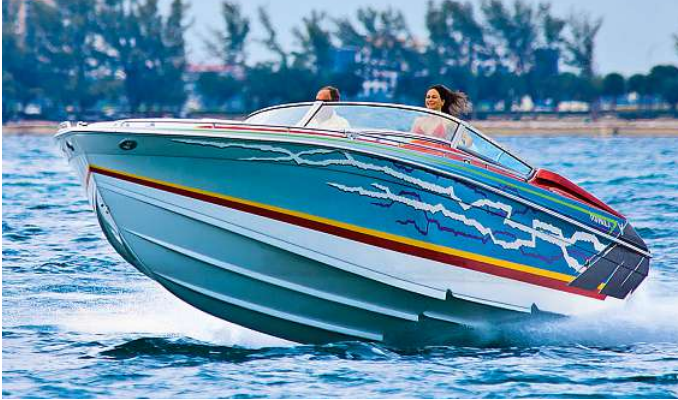
Ausgeprägte Steps kennzeichnen die Formula-Fas³Tech-Rümpfe
