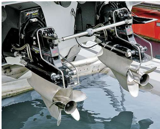
High-Performance-Rennantriebe mit fünfflügeligen Stahlpropellern, die eine Steigung von 32 Zoll aufweisen
