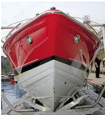
Keilförmiger Rumpf mit speziellem Fiberglas-Stringer-System und einer Aufkimmung von 24 Grad
