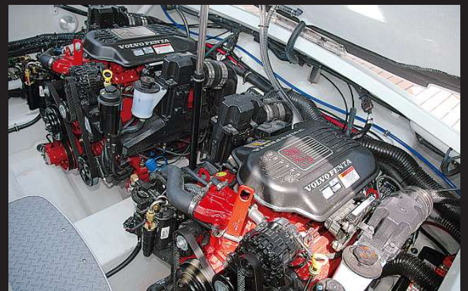
Rot lackierte „Achtender“: Die Volvo-Benziner leisten je 235 kW
